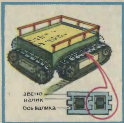
сеницах. Такой трактор предназначен для работы в тесных помещениях, например в складе. Он может резко изменять направление движения даже под углом в  $90^\circ$ . Но у такого трактора есть существенный недостаток: когда пара гусениц работает, другая пара мешает им.
