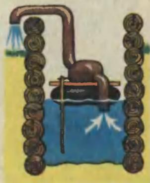
га упирается в дно, насос выключается. Когда же уровень воды снова повысится, выключатель под действием пружины вновь включит насос.
